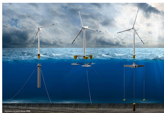
図 1.1: 浮体式風車の浮体形式 [1]
