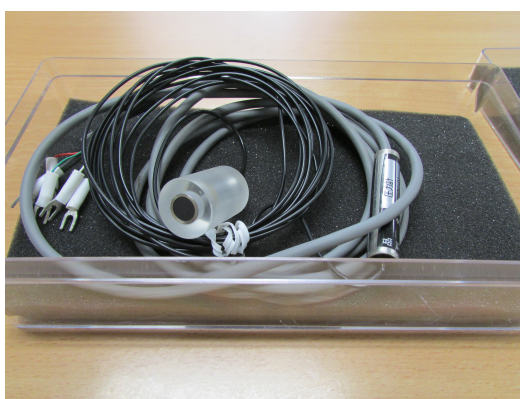
図 3.6: ひずみ式圧力計 (Marine Hydro. Lab. 所有)
