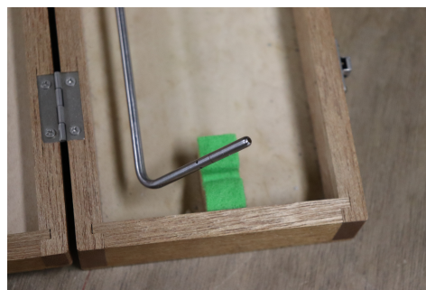
(c) ピトー管の先端部
