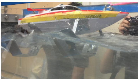
図 7: 平板翼をつけた水中翼船
