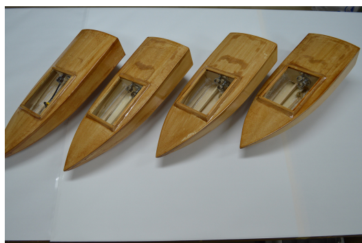
(a) 船体はパルサ材を組み合わせて製作
