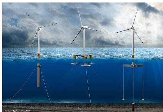
図 2.5: 浮体式風車の浮体形式 [13]
