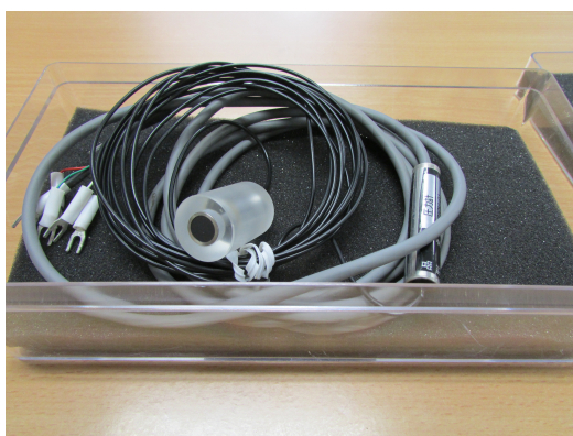
図 3.6: ひずみ式圧力計 (Marine Hydro. Lab. 所有)
