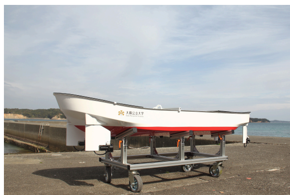
図 4.7: ロボット漁船の 1/7 モデル
