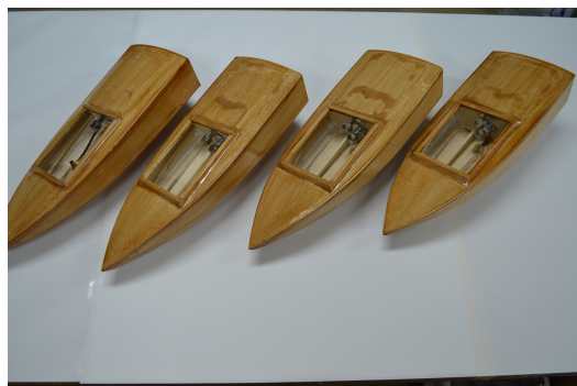
(a) 船体はバalsa材を組み合わせて製作
