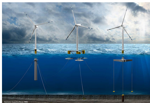
図 2.5: 浮体式風車の浮体形式 [14]
