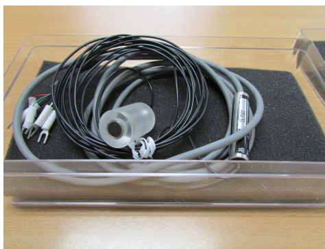
図 1: ひずみ式圧力計 (Marine Hydro. Lab. 所有)
