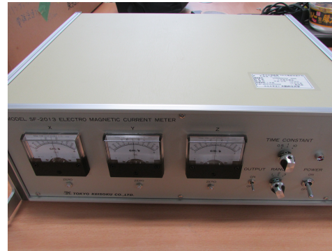
(b) 電磁流速計のアンプ部 (Marine Hydro. Lab. 所有)
