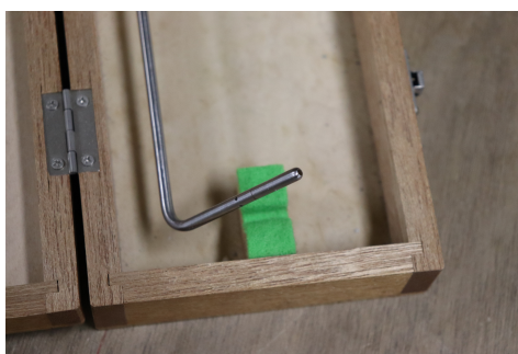
(c) ピトー管の先端部
