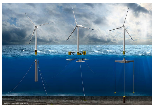
図 1.5: 浮体式風車の浮体形式 [5]
