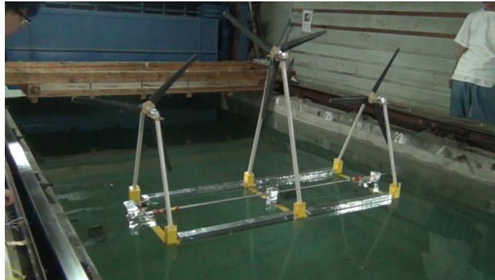
図 6: 1つの浮体に多数機の風車を搭載した新形式浮体式風車
