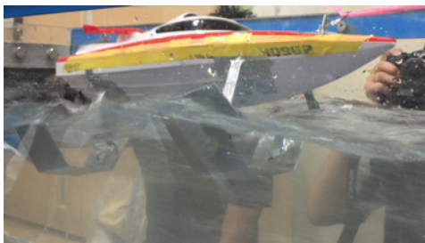
図 7: 平板翼をつけた水中翼船
