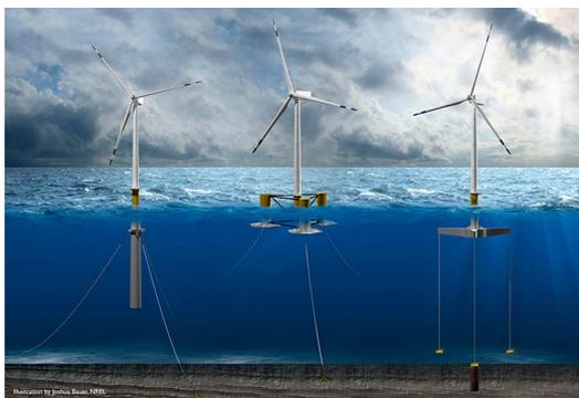
図 2.5: 浮体式風車の浮体形式 [13]
