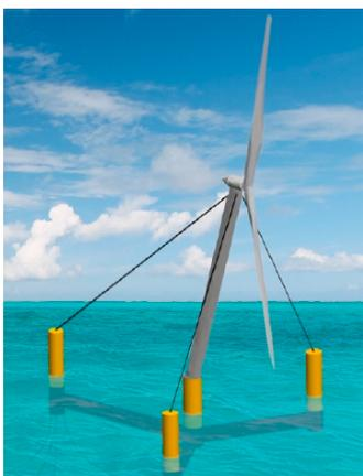
図 2.15: NEDO による一点係留式浮体式風車
