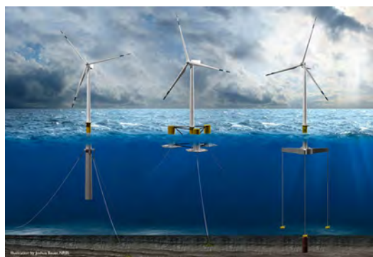
図 1.1: 浮体式風車の浮体形式 [1]
