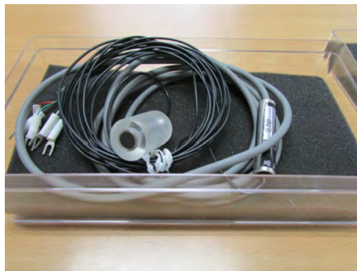
図 3.6: ひずみ式圧力計 (Marine Hydro. Lab. 所有)
