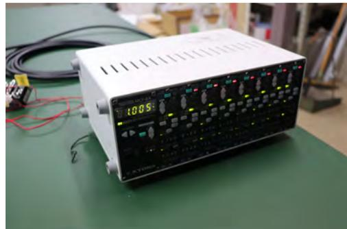
さて、波浪中のように時々刻々と電圧が変化する場合はどうしたら良いのだろうか。この場合は、データロガーというものがあり、これによりアンプの電圧をA/D(Analog / Digital)変換しPCにデータを保存することが可能となる。
