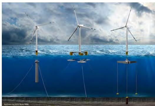
図 1.1: 浮体式風車の浮体形式 [1]
