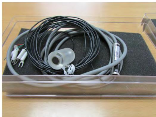
図 3.6: ひずみ式圧力計 (Marine Hydro. Lab. 所有)
